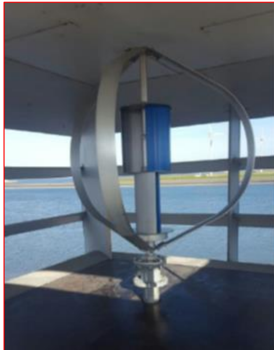
Figuur 2 - Hybride Darrieus-Savonius VAWT DS 700
