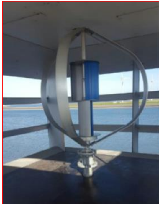
Figuur 2 - Hybride Darrieus-Savonius VAWT DS 700
